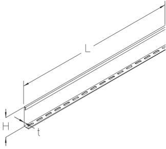
Mithilfe des Bodenkanal-Trennstegs BKRT 110 lassen sich Kabel und Leitungen mit unterschiedlichen Funktionen oder Spannungen räumlich voneinander getrennt im gleichen Bodenkanal führen. Darüber hinaus sorgen die Trennstege für eine optimale Ableitung der vertikalen Nutzlasten, die auf das System einwirken. Der Trennsteg wird mit dem Bodenkanal verschraubt. Er ist 108 mm hoch, 3000 mm lang und besteht aus sendzimir-feuerverzinktem Stahl.
