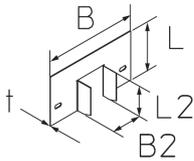
Die Bodenkanal-Reduzierung BKRKK 110 ermöglicht den Anschluss eines Kleinkanals an einen Bodenkanal. Sie hat eine Höhe von 105 mm und besteht aus sendzimir-feuerverzinktem Stahl. Der Seitenholm des Bodenkanals wird dort ausgeschnitten, wo der Kleinkanal ansetzen soll. Anschließend wird die Bodenkanal-Reduzierung am Ausschnitt verschraubt und der Kleinkanal auf die Laschen der Reduzierung geschoben.
