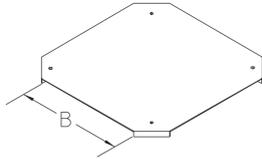
Der Bodenkanal-Kreuzung-Deckel BKKDR wird auf der Bodenkanal-Kreuzung BKK aufgesetzt und schützt Kabel und Versorgungsleitungen vor Funkenflug und anderen mechanischen Einwirkungen. Er hat der Kreuzung entsprechende Breiten von 100 bis 600 mm. Der Bodenkanal-Kreuzung-Deckel besteht aus sendzimir-feuerverzinktem Stahl ohne Prägung. Bei einer maximalen Fachgröße von 200 mm garantieren wir eine geprüfte Belastbarkeit von 5,00 kN nach EN 50085-2-2. Drehriegel sind vormontiert.
