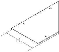
Der Bodenkanal-Deckel BKGRDR mit Gehrungsschnitt rechts wird auf dem Bodenkanal-Abzweig BKGR aufgesetzt und schützt Kabel und Versorgungsleitungen vor Funkenflug und anderen mechanischen Einwirkungen. Er hat eine dem Abzweig entsprechende Breite von 100 bis 600 mm. Der Bodenkanal-Deckel besteht aus sendzimir-feuerverzinktem Stahl ohne Prägung. Bei einer maximalen Fachgröße von 200 mm garantieren wir eine geprüfte Belastbarkeit von 5,00 kN nach EN 50085-2-2. Drehriegel sind vormontiert.
