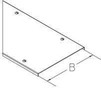
Der Bodenkanal-Deckel BKGLDR mit Gehrungsschnitt links wird auf dem Bodenkanal-Abzweig BKGL aufgesetzt und schützt Kabel und Versorgungsleitungen vor Funkenflug und anderen mechanischen Einwirkungen. Er hat eine dem Abzweig entsprechende Breite von 100 bis 600 mm. Der Bodenkanal-Deckel besteht aus sendzimir-feuerverzinktem Stahl ohne Prägung. Bei einer maximalen Fachgröße von 200 mm garantieren wir eine geprüfte Belastbarkeit von 5,00 kN nach EN 50085-2-2. Drehriegel sind vormontiert.
