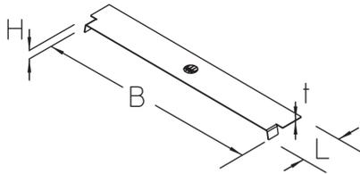
Die Bodenkanal-Deckelstoßleiste BKDSL dient der spaltfreien Abdeckung der begehbaren Bodenkanäle genau dort, wo Deckel aufeinandertreffen. Sie sorgt somit für zusätzlichen Schutz vor Funkenflug und anderen mechanischen Einwirkungen. Sie hat eine dem Bodenkanal entsprechende Breite von 100 bis 600 mm und besteht aus sendzimir-feuerverzinktem Stahl.
