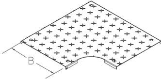
Der Bodenkanal-Bogen-Deckel BKBRDR-RHP wird auf dem Bodenkanal-Bogen BKBR aufgesetzt und schützt Kabel und Versorgungsleitungen vor Funkenflug und anderen mechanischen Einwirkungen. Er hat eine dem Bogen entsprechende Breite von 100 bis 600 mm. Der Bodenkanal-Bogen-Deckel besteht aus sendzimir-feuerverzinktem Stahl mit Rutschhemmklasse R12. Bei einer maximalen Fachgröße von 200 mm garantieren wir eine geprüfte Belastbarkeit von 5,00 kN nach EN 50085-2-2. Drehriegel sind vormontiert.
