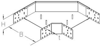
Der Bodenkanal-Bogen BKB 100 mit integrierten Verbindern ermöglicht horizontale Richtungsänderungen der Kabelführung um 90°. Er hat eine Höhe von 100 mm und weist Breiten von 100 bis 600 mm auf. Er besteht aus sendzimir-feuerverzinktem Stahl. Zur Ableitung von vertikalen Nutzlasten müssen ab einer Breite von  $\geq 300$  mm ein Trennsteg und ab einer Breite von  $\geq 500$  mm zwei Trennstege verbaut werden. Der Bogen wird in die Bodenkanäle eingeschoben und anschließend verschraubt.
