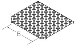
Der Bodenkanal-Abzweig-Deckel BKADR-WZB AL wird auf dem Bodenkanal-Abzweig BKA aufgesetzt und schützt Kabel und Versorgungsleitungen vor Funkenflug und anderen mechanischen Einwirkungen. Er hat eine dem Abzweig entsprechende Breite von 100 bis 600 mm. Der Bodenkanal-Abzweig-Deckel besteht aus Aluminium-Warzenblech mit Rutschhemmklasse R10. Bei einer maximalen Fachgröße von 200 mm garantieren wir eine geprüfte Belastbarkeit von 3,00 kN nach EN 50085-2-2. Drehriegel sind vormontiert.
