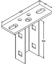
Die Kopfplatte BGU 40 dient der Deckenmontage des Konsolhalters KHU 40. Sie wird an diesen angeschraubt und an die Decke gedübelt. Verschiedene Materialien und Oberflächen sorgen dafür, dass die Korrosionsanforderungen unterschiedlichster Anwendungsgebiete erfüllt werden.
