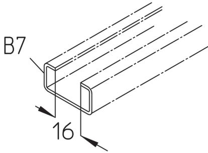
Die Profilschiene B 7 ist ungelocht und besteht aus einem C-Profil 30 x 15 mm mit einer Schlitzweite von 16 mm (Materialstärke = 1,5 mm). Verschiedene Materialien und Oberflächen sorgen dafür, dass die Korrosionsanforderungen unterschiedlichster Anwendungsgebiete erfüllt werden. Sie ist in den Längen 3000 oder 6000 mm lieferbar.
