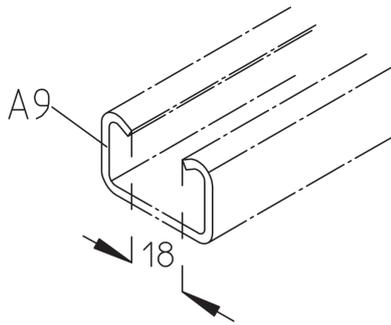
Die Profilschiene A 9 ist ungelocht und besteht aus einem C+-Profil 39,5 x 25 mm mit einer Schlitzweite von 18 mm (Materialstärke = 2,75 mm). Verschiedene Materialien und Oberflächen sorgen dafür, dass die Korrosionsanforderungen unterschiedlichster Anwendungsgebiete erfüllt werden. Sie ist in den Längen 3000 oder 6000 mm lieferbar.
