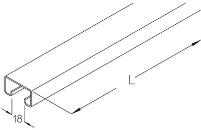
Die Profilschiene A 7 ist ungelocht und besteht aus einem C+-Profil 39,5 x 22 mm mit einer Schlitzweite von 18 mm (Materialstärke = 1,5 mm). Verschiedene Materialien und Oberflächen sorgen dafür, dass die Korrosionsanforderungen unterschiedlichster Anwendungsgebiete erfüllt werden. Sie ist in den Längen 3000 oder 6000 mm lieferbar.
