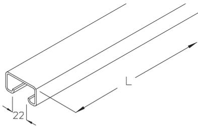
Die Profilschiene A 4 ist ungelocht und besteht aus einem C+-Profil 48 x 26 mm mit einer Schlitzweite von 22 mm (Materialstärke = 2,5 mm). Verschiedene Materialien und Oberflächen sorgen dafür, dass die Korrosionsanforderungen unterschiedlichster Anwendungsgebiete erfüllt werden. Sie ist in den Längen 3000 oder 6000 mm lieferbar.
