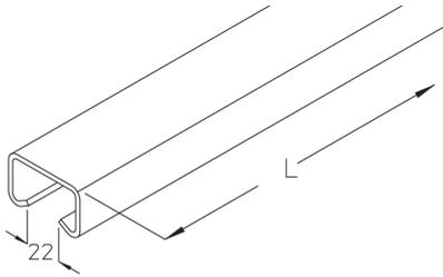
Die Profilschiene A 2 ist ungelocht und besteht aus einem C+-Profil 50 x 31 mm mit einer Schlitzweite von 22 mm (Materialstärke = 3,25 mm). Verschiedene Materialien und Oberflächen sorgen dafür, dass die Korrosionsanforderungen unterschiedlichster Anwendungsgebiete erfüllt werden. Sie ist in den Längen 3000 oder 6000 mm lieferbar.
