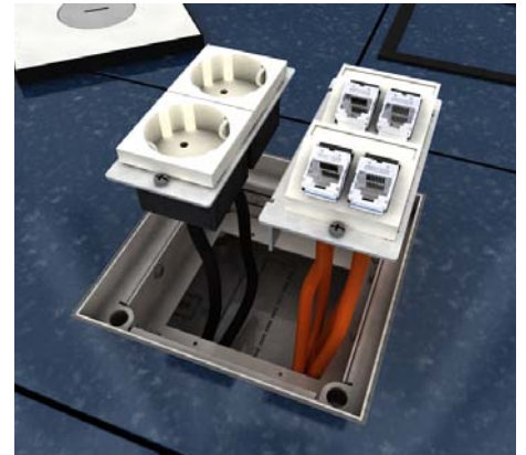
9 | Installationsgeräte Steckdosen und Datentechnik in Platinen in den Kabelauslass-Kompakteinzelanschluss (UKE160 V) einrasten und Leitungen anschließen.
