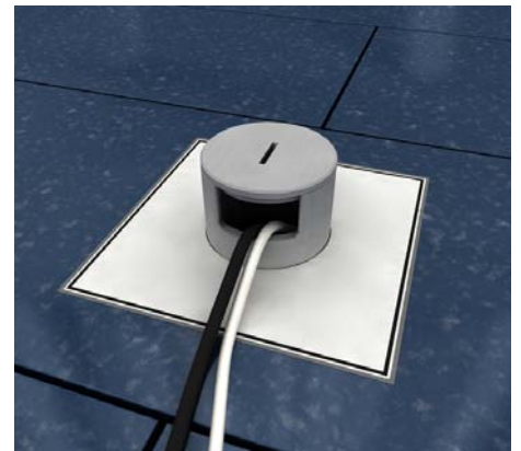
12 | Tubus Gummidichtungen und Tubusdeckel einlegen. Kabel durch Tubusauslass herausführen. Bei nass gepflegten Böden Tubuseinzelanschluss einbauen. Potentialausgleich beachten.
