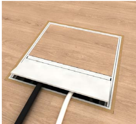
8 | Einzelauslass Gummidichtung und Kassettendeckel einlegen. Deckel mittels Öffnungshebel öffnen und Kabel durch den geöffneten Kabelauslass ausführen. Bei trocken gepflegten Böden Kassetteneinbaueinheit mit Kabelauslass einbauen. Potentialausgleich beachten.
