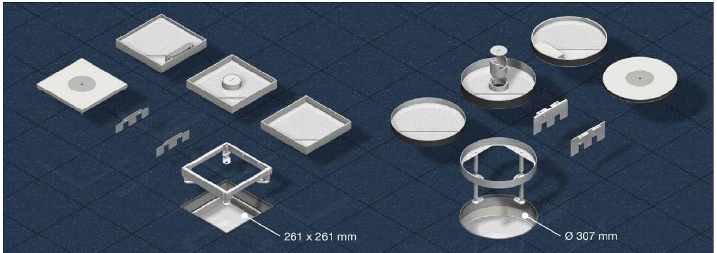
Nivellierbare Edelstahleinbaukassetten in runder und viereckiger Ausführung als Blind-, Kabelauslass- oder Tubuskassetten mit Stahleinlagen für Verkehrslasten bis 10 oder 20 kN.
