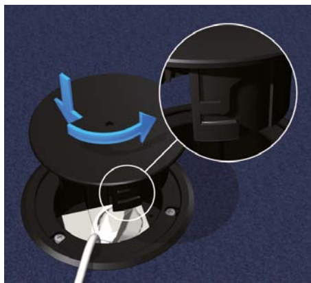
5 | Kabelauslass Stecker einbringen und Kabelauslassdeckel gegen den Uhrzeigersinn mittels Bajonetverschluss einsetzen.
