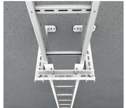
6 | Pendelabhängung Pendelabhängung aus Profilen (z. B. KHU 60) mit Quertraverse und Holmstützen (WPHS-K) an Betondecke gedübelt.
