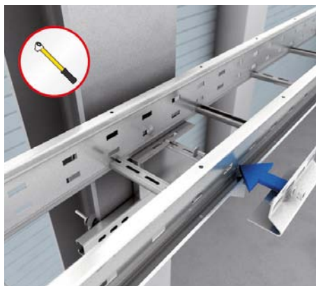
5 | Vordere Holmstütze Vordere Holmstütze (WPHS) auf die Konsole schieben und zusammen mit der Weitspannkabelleiter und der Konsole verschrauben.
