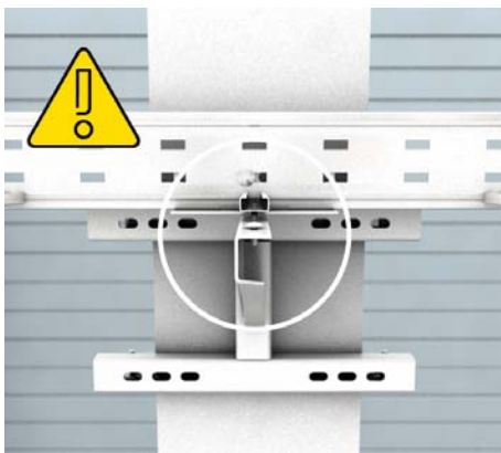
4 | Sprossen Achtung: Die Holmstütze (WPHS) muss mit der Konsole verschraubt werden. Auch wenn die Sprosse direkt über der Konsole positioniert wird.
