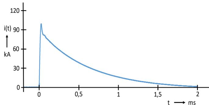
Vor und nach der Prüfstrombelastung wurde der elektrische Übergangs-Widerstand an der Klemmstelle bestimmt. Sowohl vor als auch nach der Prüfstrombelastung war der elektrische Übergangs-Widerstand innerhalb der zulässigen Toleranzen nach DIN EN 62561-1. Das Lösedrehmomente der Schrauben waren ebenfalls innerhalb der zulässigen Toleranzen.
