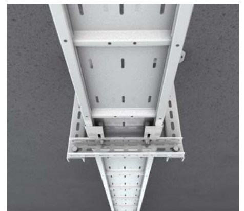
6 | Pendelabhängung Pendelabhängung aus Profilen (z. B. KHU 60) mit Quervertraverse und Holmstützen (WPHS-K) an Betondecke dübeln.
