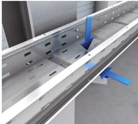
2 | Holmstütze Weitspannkabelrinne aufsetzen und gegen die verschraubte Holmstütze (WPHS) schieben. Auf richtige Lage der Weitspannkabelrinne achten!
