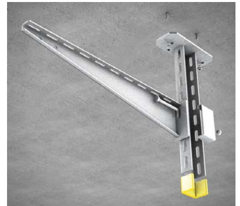
6 | Deckenmontage mit schwerem Konsolhalter KDU 60 Die Montage erfolgt mittels zweier Dübel, z.B. SD 10/10*. Die Konsole KW wird mit Schraubensatz KLS 10x20* befestigt. Ab einer Konsollänge von 500 mm ist das Stützstück KHUSS zusammen mit der Konsole zu verschrauben. Die optionale Schutzkappe SU 60* wird von unten aufgeschoben.
