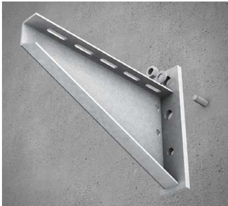
1 | Wandmontage mit schwerer Konsole KWS Die Montage erfolgt mittels Dübel, z.B. SD 12/10*, in der obersten Bohrung.
