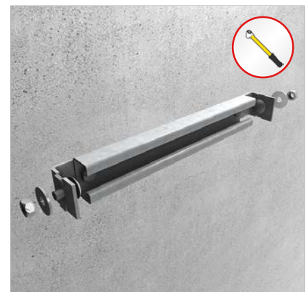
Zusätzliche Sprossen STUS für den nachträglichen Einbau Zusätzlich benötigte Sprossen (STUS)* werden im gewünschten Abstand über die Befestigungslasche (BL 6) mit dem Seitenholm von innen verschraubt.
