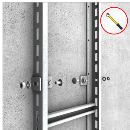
oder außenliegend verschrauben und z.B. mit Stahlspreizdübel (SD 10/10)* im max. Stützabstand von 1.500 mm an Betonwand dübeln.
