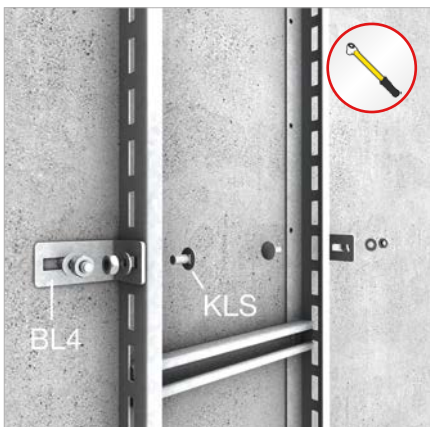
Wandbefestigung mit Befestigungslasche BL 4 Befestigungslasche (BL 4)* mittels Klemmschraube (KLS 10x20)* mit dem Steigtrassenholm innen-
