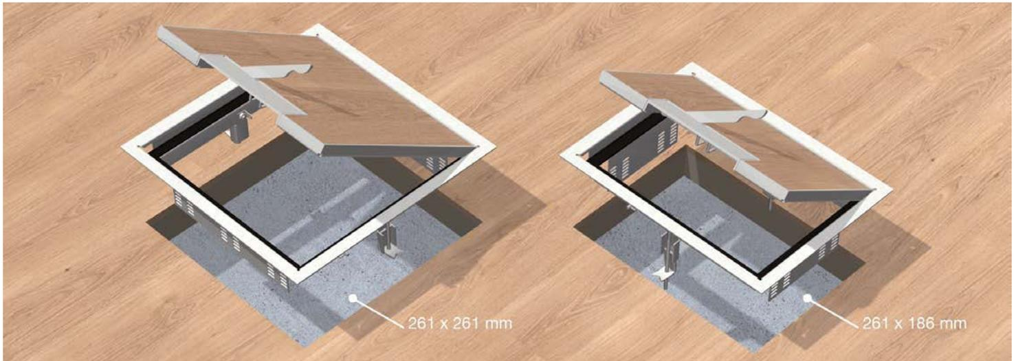
Viereckige Kassetteneinbaueinheiten mit Teppichschutzrahmen aus Edelstahl mit den Außenmaßen 284 x 284 mm oder 284 x 211 mm zum Einbau in Hohlraum- oder Doppelböden. Für Parkettbelag 12/22 mm.
