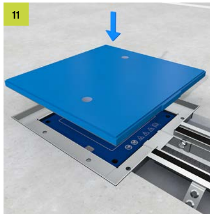
Der Spezialdeckel wird in die Lade-schutzzeinhauser aufgelegt und liegt nun bündig auf dem Seitenrand der Kassette. Die Flächen sollten frei von Schmutz sein.
