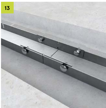
Kanalverlängerung: Kanalunterteile aneinander schieben und mittels Innenverbinder UBKV miteinander verschrauben.
