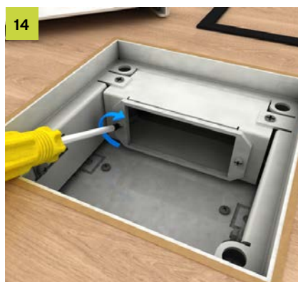
14 Installationsgeräte Installationstechnik von vorne in die Einbauplatine (UGEE3) einrasten, Anschlussleitung montieren und die gesamte Komponente mit dem Geräteträger verschrauben.
