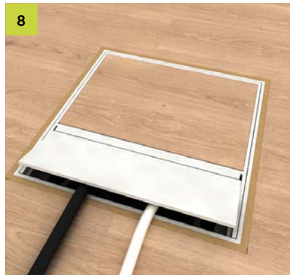
8 Einzelanschluss Gummidichtung und Kassettendeckel einlegen. Deckel per Öffnungshebel öffnen. Kabel durch den geöffneten Kabelauslass ausführen. Bei trocken gepflegten Böden Kassetteneinbaueinheit mit Kabelauslass einbauen. Potentialausgleich beachten.
