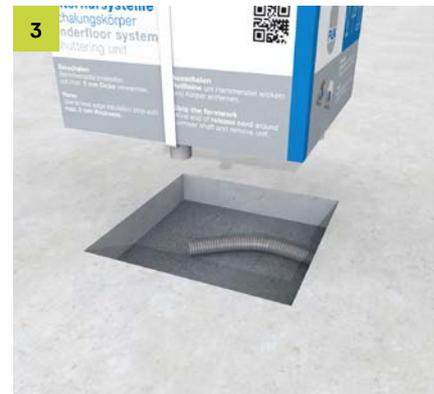
3 Nach Aushärten des Estrichs den Schalungskörper mit Hilfe der Reißleine sorgsam entfernen.
