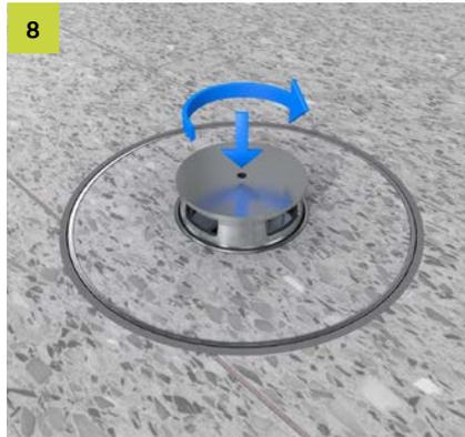
Tubusauslass umdrehen, in die Öffnung einsetzen und mit dem Tubusdeckel komplettieren. Pflegehinweis und Potentialausgleich beachten.
