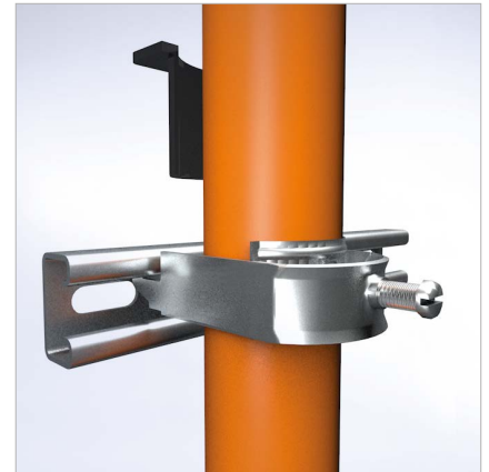
Die Gegenwanne von oben, hinter dem Kabel entlang, einführen. Sie liegt mit ihren Laschen auf den Schellenwänden auf und kann nicht mehr verrutschen.
