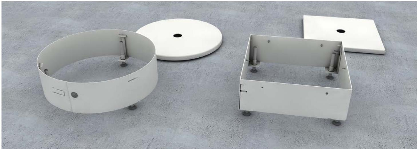
Überschleifbarer Schalungskörper (UNSKH), rund und eckig, nivellierbar von 96 mm bis 155 mm. Einbaumaße  $\varnothing$  308 mm (rund) und 261 x 261 mm (viereckig). Für überschleifbare Gussasphalt- und Estrichböden, bestehend aus einem faltbaren Körper, Nivellierfüßen und überschleifbarem Deckel.
