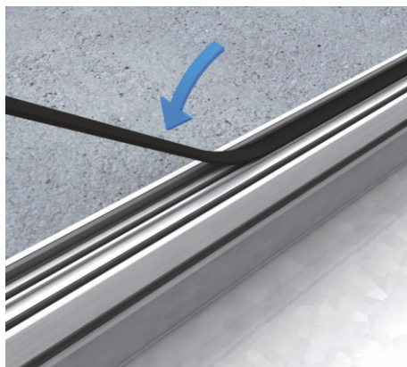
38 | Przygotowanie kanału UEBS do powierzchni pokrytej linoleum czyszczonym na mokro Następnie wkleić gumową uszczelkę (UGDB15-R300 1.8) wzdłuż profili bocznych na całej długości kanału.
