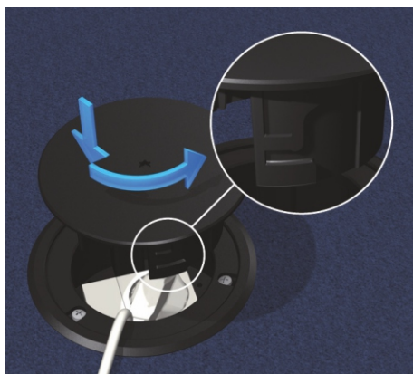
5 | Montaż tubusa Wtyczkę umieścić prawidłowo w gniazdku i nałożyć pokrywę wprowadzając przewód w otwór boczny tubusa. Pokrywkę zablokować poprzez umieszczenie jej w otworze kasety oraz obrót w kierunku przeciwnym do kierunku ruchu wskazówek zegara.
