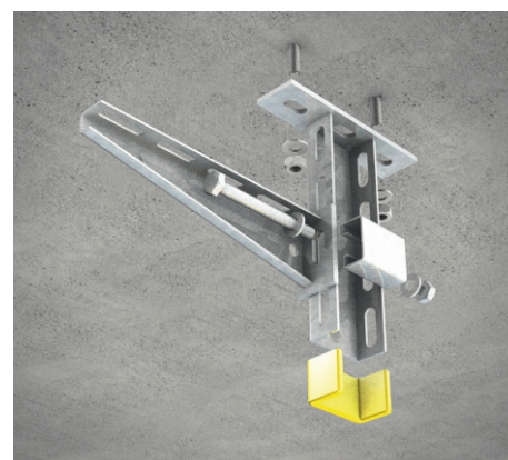
3 | Montaż sufitowy z wspornikiem pionowym KDU 57 Do montażu KDU 57 użyć dwóch kołków, np. SD 10/10*. Wspornik poziomy KW zamocować stosując zestaw KHUSS 57. Opcjonalnie, nakładając od dołu, zabezpieczyć zakończenie kształtownika nakładką ochronną SU 57*.
