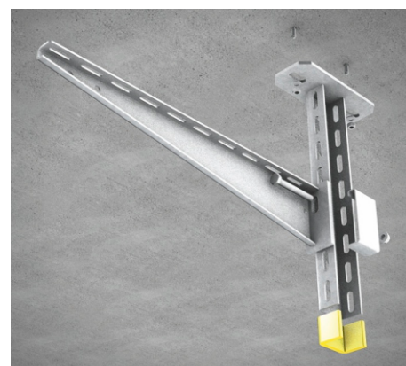
6 | Montaż sufitowy wspornika pionowego KDU 60 Do montażu KDU 60 użyć dwóch kołków, np. SD 10/10*. Wspornik KW zamocować stosując KLS 10x20*. Przy wsporniku dłuższym niż 500 mm, stosować śrubę wraz z elementem dystansowym KHUSS 60. Opcjonalnie, nakładając od dołu, zabezpieczyć zakończenie kształtownika nakładką ochronną SU 60*.
