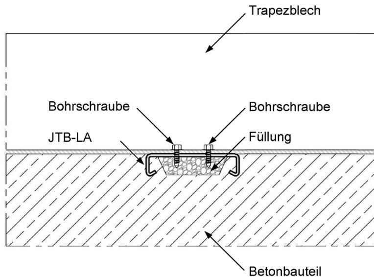
**JORDAHL Trapezblechbefestigung JTB-LA als Verankerung in Betonbauteilen**
