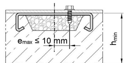
JORDAHL Trapezblechbefestigung JTB-LA als Verankerung in Betonbauteilen
