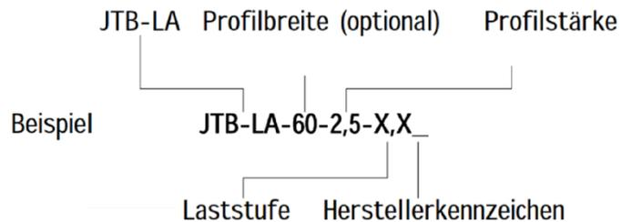
**JORDAHL Trapezblechbefestigung JTB-LA als Verankerung in Betonbauteilen**
