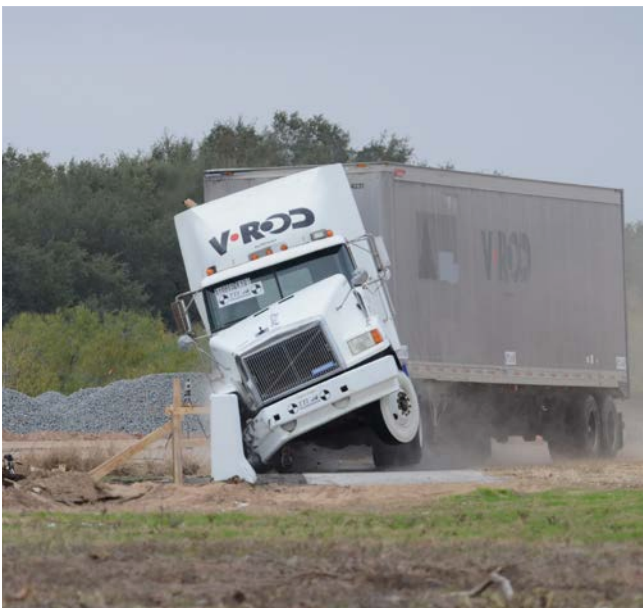
Anprallversuch eines 36.000 kg schweren Lkw mit 80 km/h an eine mit FIBERNOX® V-ROD bewehrte Normleitplanke
