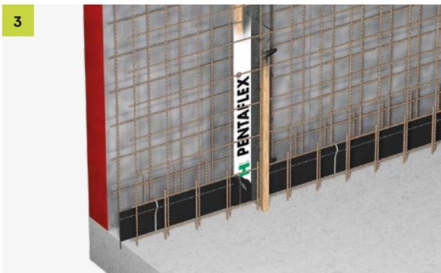
Innere Bewehrung einstellen und mit dem ABS Element verbinden (Bindedraht, schweißen). Trapezleiste befestigen und Schalung schließen. WU-taugliche Spannstellen verwenden.
