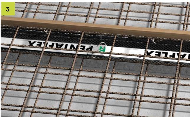
Verlegen der oberen Bewehrung und Abschalen der oberen Betondeckung. ABS Element an der oberen Bewehrung mittels Bindedraht befestigen.
