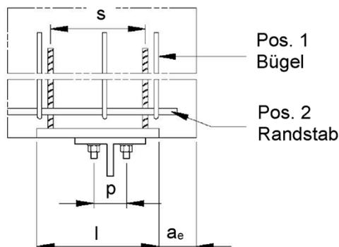
JORDAHL Geländerbefestigungsschiene JGB zur Verankerung im Beton
