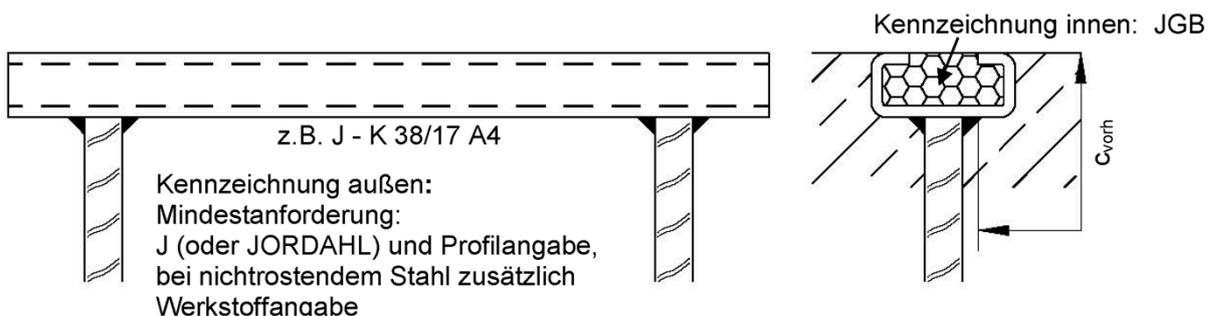
JORDAHL Geländerbefestigungsschiene JGB zur Verankerung im Beton
