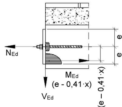
JORDAHL Geländerbefestigungsschiene JGB zur Verankerung im Beton
