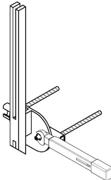
JORDAHL Geländerbefestigungsschiene JGB zur Verankerung im Beton
