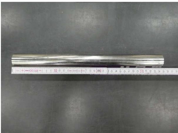
Abbildung 2: Kurzer Stahldorn (J50) zum Lager SINTON® Q mit 350 mm Länge und 35 mm Durchmesser.
