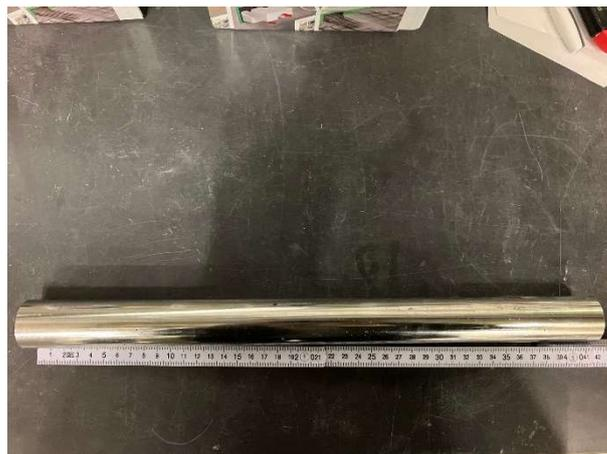
Abbildung 3: Langer Stahldorn (J120) zum Lager SINTON® Q mit 420 mm Länge und 35 mm Durchmesser.
