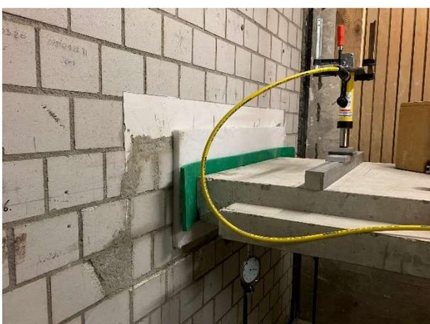
Abbildung 6: Fugendämmstoff SINTON® S und Dämmmaterial zwischen der Wand und dem Podest bei einer Fugenbreite von 50 mm.
