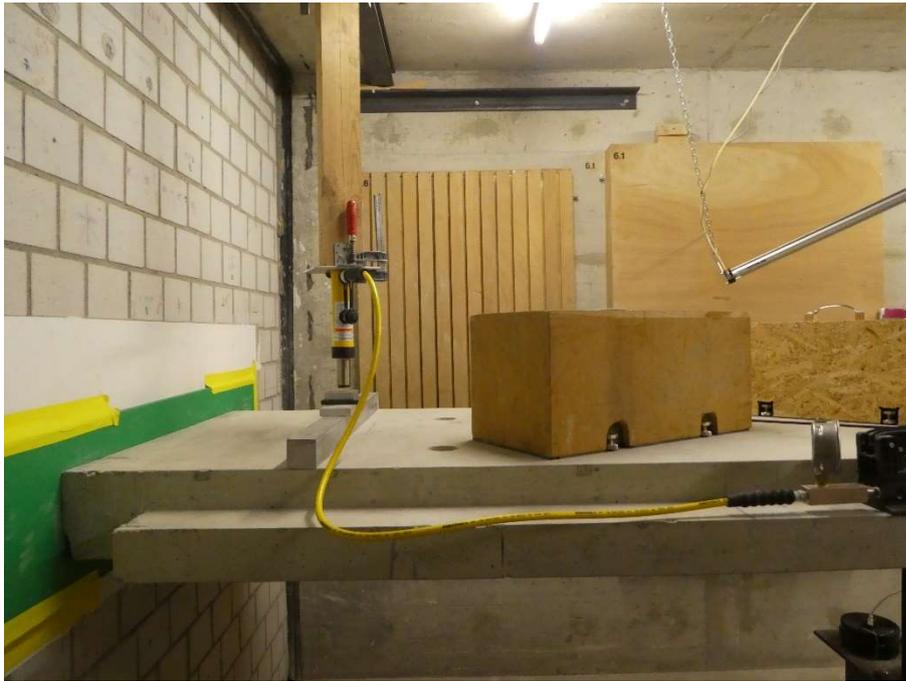
Abbildung 14: Übersicht der Einbausituation und Hammerwerkspositionen auf dem Podest
