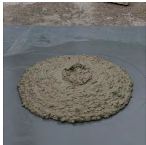
Abbildung 4: Betonkuchen nach Ermittlung des Setzfließmaßes.
