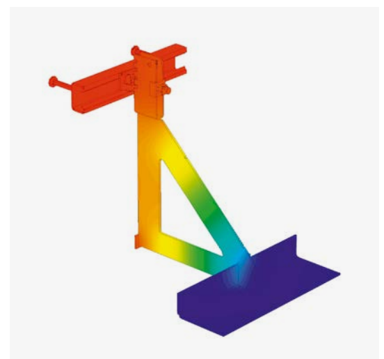
Temperaturverlauf Verblenderkonsole JVAeco+ P
