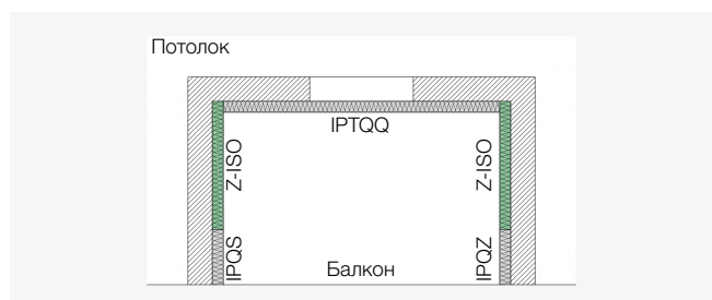
ISOPRO® Z-ISO — лоджия с точечной опорой с IPQS/IPQZ
