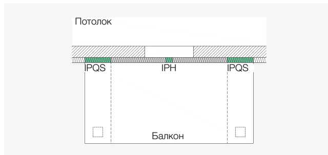
ISOPRO® IPQS — балкон на опорах с опорными балками и точечной опорой с элементами ISOPRO® IPQS
