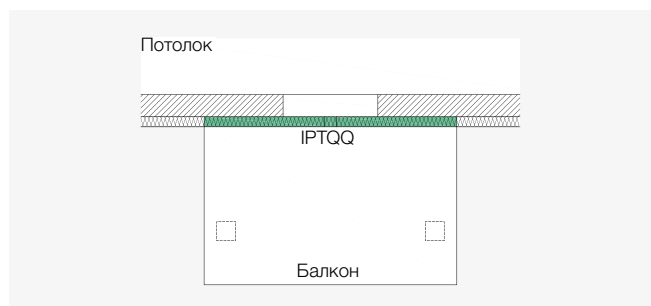
ISOPRO® IPTQQ — балкон на опорах, с опорами с отступом
