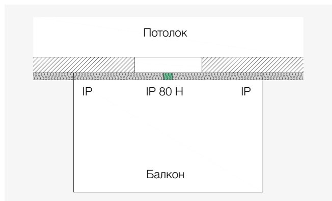
ISOPRO® 80 H — балкон с выносом с горизонтальными усилиями, возникающими в соответствии с проектом
