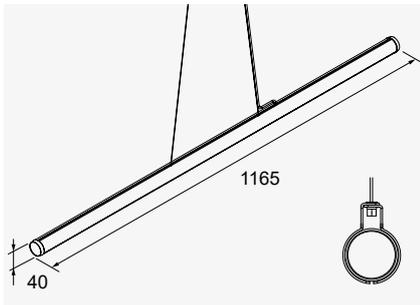
LED-Pendelleuchte mit Clip und Drahtseilen; 24 Vdc; 58 Watt; 5.436 Lumen (brutto); Energieeffizienzklasse (EEK): G; inkl. LED-Leuchtmittel mittlere Lebensdauer: 50.000 h; drehbar im Halteclip für direktes/indirektes Licht; Korpus Aluminium mit diffus streuender Acrylabdeckung für homogene Ausleuchtung; IP20; wahlweise dimmbar/nicht dimmbar; 2x Stahlseile 250 cm mit Seiljustierern; 1x Abgangskabel 250 cm mit Stecker zur Adaption an das externe Netzteil; Netzteil separat erhältlich.
