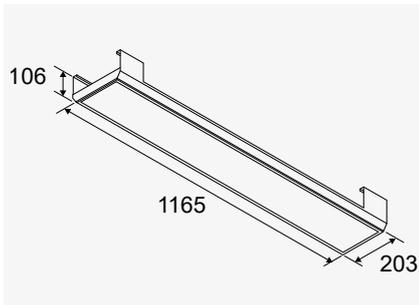
LED-Flächenleuchte mit integrierter Halterung für Kabelrinne 60 mm hoch und 200 mm breit; Betrieb mit 2.100 mA konstant; Energieeffizienzklasse (EEK): F; dimmbar, PMMA-Abdeckung für homogene Ausleuchtung; primärseitig Abgangskabel 2.000 mm mit Stecker; sekundärseitig 500 mm Kabel mit Stecker zur Adaption an das externe Netzteil; Netzteil separat erhältlich; auf Anfrage Netzteil vorprogrammiert mit 100% oder 90% Leistung; bei 90% Leistung UGR<90; IP20
