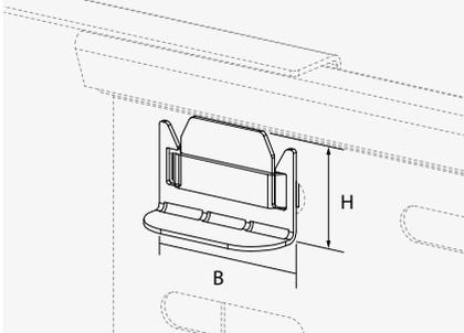
Sicherung für Verbindung von Formteil mit Kabelrinne über Rastbrücke
