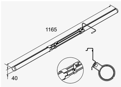
LED-Anbauleuchte mit Halteclip für Kabelrinne Höhe 60 mm; 24 Vdc, 58 Watt, 5.436 Lumen (brutto); Energieeffizienzklasse (EEK): G; inkl. LED-Leuchtmittel mittlere Lebensdauer: 50.000 h; drehbar im Halteclip für direktes/indirektes Licht; Korpus Aluminium mit diffus streuender Acrylabdeckung für homogene Ausleuchtung; IP20; wahlweise dimmbar/nicht dimmbar; 50 cm Abgangskabel mit Stecker zur Adaption an externes Netzteil; Netzteil separat erhältlich.
