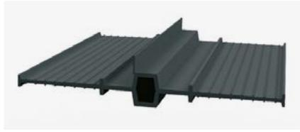
KUNEX® Dehnfugenband innenliegend aus PVC-P zur Abdichtung von Dehnfugen in Betonbauwerken. Das Fugenband nimmt Dehn- und Scherbewegungen auf. Einbau mittig im Betonquerschnitt.
