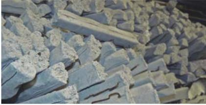
Dreikant-Flächenabstandhalter aus Faserbeton mit Haken für senkrechte Bewehrung. Geprüft gemäß DBV-Merkblatt „Abstandhalter“ auf Frost- und Tauwechselbeständigkeit, Wassereindringtiefe, Kippstabilität und Druckfestigkeit. Farbzuschlag und andere Abmessungen auf Anfrage
