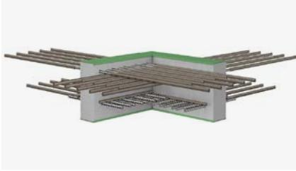
Wärmedämmter Plattenanschluss zur Verbindung von frei auskragenden Stahlbetonbauteilen mit Außenecken. Korrosionsschutz durch nichtrostenden Betonrippenstahl. Brandschutzausführung lieferbar.
