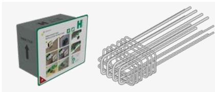
Trittschalldämmelement mit typengeprüftem Bewehrungskorb in zwei Laststufen T1 und T2. Aussparungselement zur Auflagerung und gleichzeitig schalltechnischen Trennung von Podest und Treppenhauswand. Lieferung inkl. Füllkörper zur Stabilisierung im Betonierzustand und Rahmen zur Befestigung an der Schalung.
