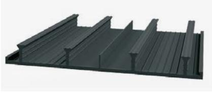
KUNEX® Arbeitsfugenband außenliegend aus PVC-P zur Abdichtung von Arbeitsfugen in Betonbauwerken. Einbau oberflächenbündig am Betonbauteil.
