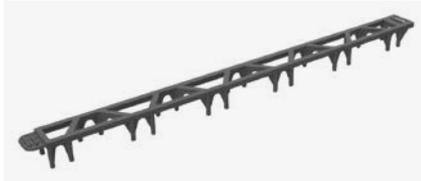
Linienförmiger Abstandhalter aus Kunststoff mit punktueller Auflage für horizontale Matten- und Rundstahlbewehrung. Speziell für den Einsatz im Fertigteilwerk geeignet.
