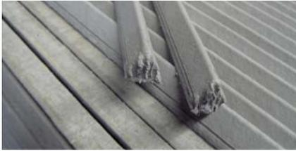
Dreikant-Flächenabstandhalter aus Faserbeton für horizontale Matten- und Rundstahlbewehrung. Geprüft gemäß DBV-Merkblatt „Abstandhalter“ auf Frost- und Tauwechselbeständigkeit, Wassereindringtiefe, Kippstabilität und Druckfestigkeit.
