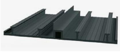
KUNEX® Dehnfugenband außenliegend aus PVC-P zur Abdichtung von Dehnfugen in Betonbauwerken. Das Fugenband nimmt Dehn- und Scherbewegungen auf. Einbau oberflächenbündig am Betonbauteil.
