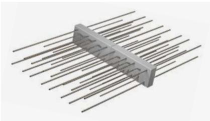
Wärme gedämmter Plattenanschluss für durchlaufende Stahlbetondecken. Korrosionsschutz durch nichtrostenden Betonrippenstahl. Brandschutzausführung lieferbar.
