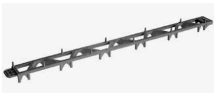
Linienförmiger Abstandhalter aus Kunststoff mit punktueller Auflage für horizontale Matten- und Rundstahlbewehrung. Speziell für den Einsatz im Fertigteilwerk geeignet. Nach oben stehende Noppen verhindern das Verrutschen der Bewehrung. Guter Betondurchfluss.
