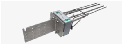
Wärme gedämmter Anschluss zur Übertragung von Biegemoment und Querkraft sowie Horizontalkräften beim Anschluss einer auskragenden Holzkonstruktion an ein Stahlbetonbauteil.
