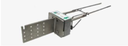
Wärmegeädämter Anschluss zur Übertragung von Querkraft sowie Horizontalkräften beim Anschluss einer gestützten Holzkonstruktion an ein Stahlbetonbauteil.
