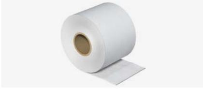
Einseitig selbstklebendes Dichtungsband mit aufkaschierter HDPE-Folie zur wasserseitigen Verbindung von Stumpfstoßen, zur Korrektur von Fehlstellen oder Schließen von Spannstellen-Durchdringungen.
