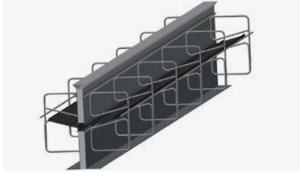
Zweiteiliges Abschalelement für den einfachen Einbau von innenliegenden KUNEX® Fugenbändern in wasserundurchlässigen Dehnfugen im Stahlbetonbau mit einer Breite von 20 mm. Die Elemente sind geeignet für die Dehnfugenbänder KUNEX® D240 in Kombination mit Bodenplattendicken von 240 mm bis 500 mm. **Das KUNEX® Fugenband ist gesondert zu bestellen.**
