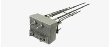
Wärmedämmelement zur Übertragung von Biegemoment und Querkraft beim Anschluss einer auskragenden Stahlkonstruktion an eine Stahlbeton-Geschossdecke.
