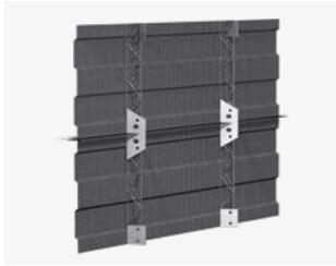
Abschalelement als verlorene Schalung in Arbeitsfugen. Ausführung als verzahnte Fuge nach DIN EN 1992-1-1/NA. Die Ausführung A V-S ist mit einer Gitterträgerkonstruktion als Verstärkung versehen.
