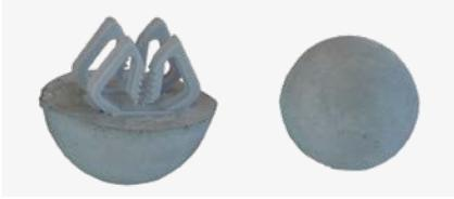
Einzelabstandhalter mit geringer Aufstandsfläche aus Gießbeton mit Kunststoffklammer zur Befestigung an der Bewehrung. Keine Metall- und Drahtteile in der Betondeckung.
