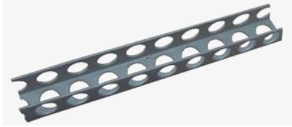
Linienförmiger Abstandhalter aus Kunststoff für großflächige horizontale Bewehrungslagen. Speziell für den Einsatz auf weichem Untergrund wie z. B. Dämmplatten geeignet. Guter Betondurchfluss.
