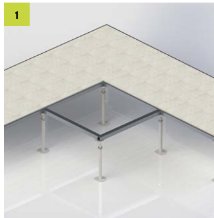
1 Entfernen der Bodenplatte am gewünschten Ladepunkt im Reinraum.
