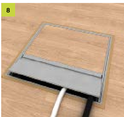
8 Einzelanschluss Gummidichtung und Kassettendeckel einlegen, Kabel durch den Kabelauslass herausführen. Bei trocken gepflegten Böden Kassetteneinbaueinheit mit Kabelauslass einbauen. Potentialausgleich beachten.
