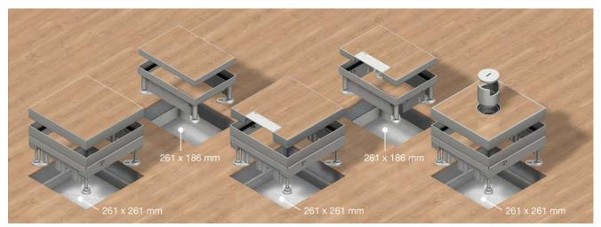
Eckige Kassetteneinheit mit Stosskante aus Edelstahl als Blind-, Kabelauslass-, und Tubukassetteneinheit zum Einbau in Estrichund Hohlraumböden. Für Parkett- und Steinbeläge 12/22/32/42 mm und Linoleum in Kombination mit Hartschaumdeckeleinlage verwendbar. Nivellierbar von 65 bis 315 mm.
