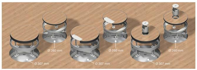
Runde Kassetteneinheit mit Stoßkante aus Edelstahl mit einem Außendurchmesser von 307mm als Blind-, Kabelauslass-, und Tubuskassetteneinheit zum Einbau in Estrich- und Hohlraumböden. Für Parkett- und Steinbeläge 12/30 mm und Linoleum in Kombination mit Hartschaumdeckeleinlage verwendbar. Nivellierbar von 100-155 mm.
