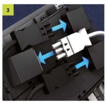
Anschlussleitungen Leitungen nach Farbe (schwarz: Normalnetz, weiß: EDV-Netz) und Länge auswählen. Das Buchsenteil der 3-poligen Verbindungsleitung an das Snap-In Teil im Gerätebecher einstecken.
