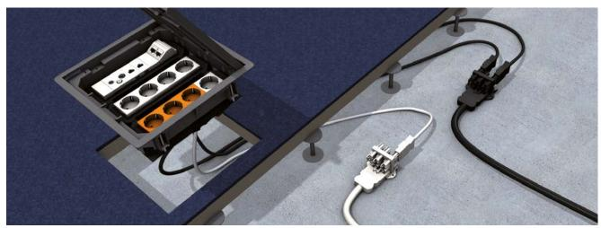
Vorkonfektionierter Gerätebecher komplett mit Snap-In Steckerteil und vorverdrahteten Steckdosen. Inklusive aller Abdeckungen und Montagematerialien. Zum Einrasten in eine runde oder eckige Einbaueinheit. Für bis zu vier Installationsgeräte der Starkstromtechnik. Zum Anschluss von 3-poligen Verbindungsleitungen mit Stecker und Buchsenteil.
