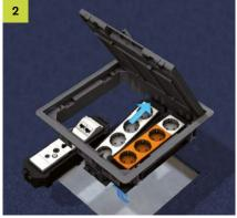
**Geräteeinbaubecher**Die vorkonfektionierten Gerätebecher in die Rastleitern der Einbaueinheit so tief wie möglich einsetzen.
