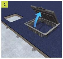
Hohlraum- und Doppelböden Bei Hohlraum- oder Doppelböden die Einbaueinheit direkt in die Einbauöffnung einsetzen.
