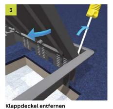
Deckel ganz öffnen, rechts kräftig nach vorne ziehen und mit Hilfe eines Schraubendrehers aus dem Scharnier lösen.
